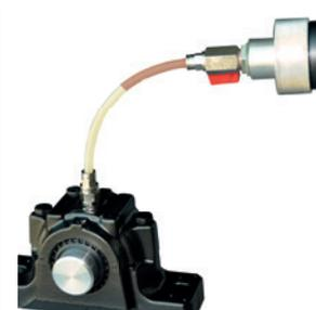
Подключите шланг и заполните магистраль смазкой с помощью смазочного шприца
