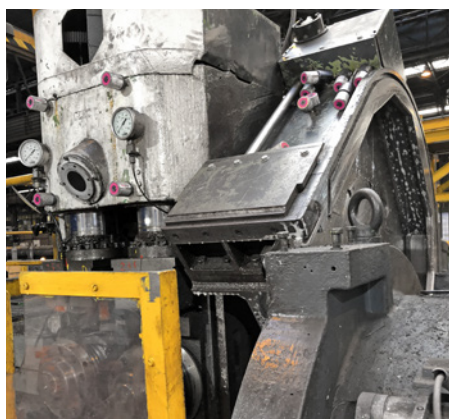
Несколько лубрикаторов simalube и IMPULSE смазывают колонны (слева) и привод (справа) висечного станка.
