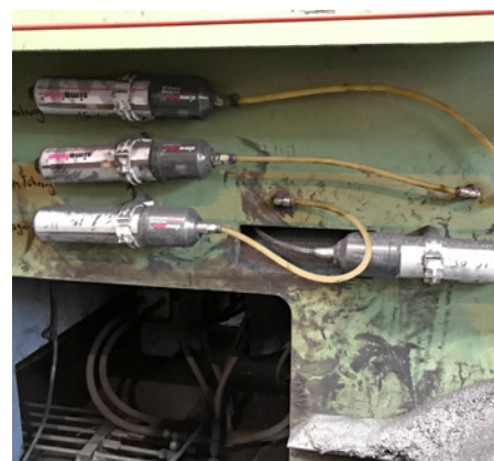
Благодаря усилителю давления simalube IMPULSE точки смазки на заводе (подшипники, направляющие втулки и блокировки) могут быть установлены удаленно и смазываться при помощи трубки.
