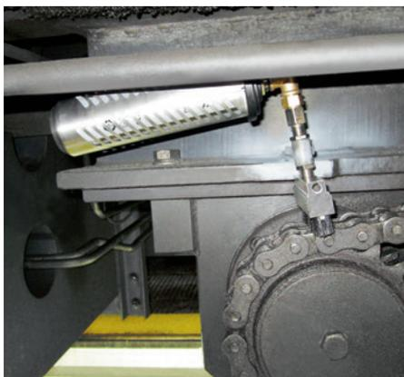
Лубризатор *simalube* 250ml смазывает приводную цепь рельсового крана. Защитный чехол защищает лубризатор от механических повреждений.
