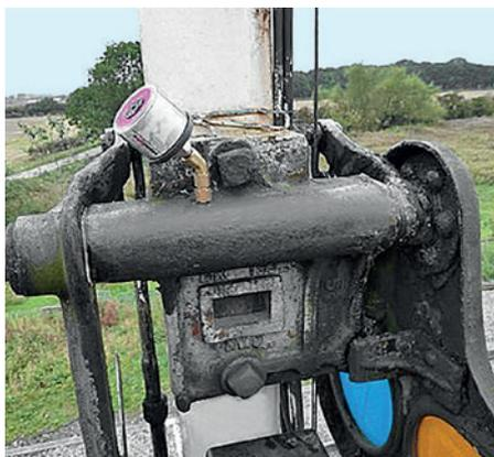
Подшипник скольжения железнодорожного сигнала автоматически и непрерывно смазывается лубрикаторм *simalube* 30 мл.
