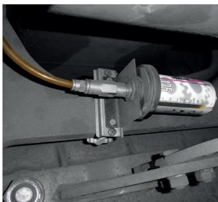
Лубрикатор 125 мл устанавливается на шасси низкопольного трамвая. Смазка подается через трубку в точку смазки.
